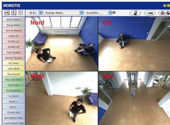
Wählen Sie im QuickControl **Anzeige-Modus** die Option **Surround bzw. Panorama**. Die Feineinstellung der Ansichten erfolgt über vPTZ via Maus oder Joystick und – wie bereits oben beschrieben – über Ent- und Verriegeln der Standardansicht über das symbolisierte Schloss (Schloss öffnen – Anzeige korrigieren – Schloss wieder schließen).
